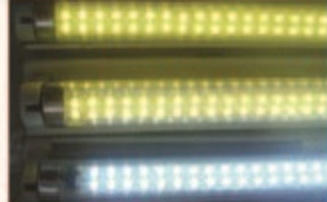
รูปที่ 6 การมองเห็นเม็ดหลอดแอลอีดีโดยพบ จะเห็นแสงจ้า ที่ตาทำให้เกิดสภาพ แสงจ้า (glare)
