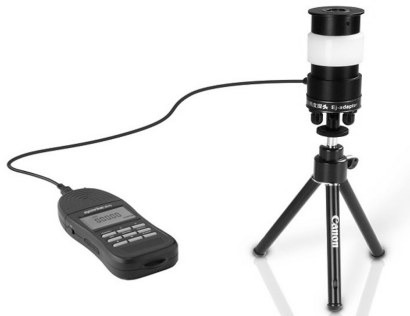
หัววัดแสงสำหรับการวัด ความส่องสว่างทรงกระบอก
