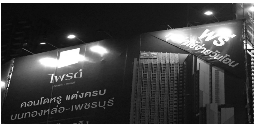
รูปที่ 2 การสะท้อนบดบังที่เกิดขึ้นบนพื้นผิวที่มีความมันวาว
